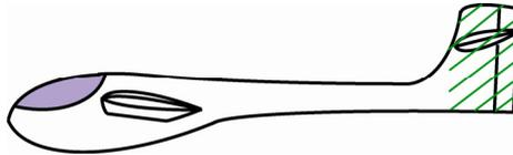
Figure 5 : Position de l'empennage vertical.
