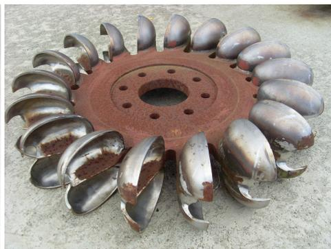
**Roue d'une turbine Pelton (source : [http://commons.wikimedia.org/wiki/File:Pelton\\_400kW\\_roue\\_1.JPG](http://commons.wikimedia.org/wiki/File:Pelton_400kW_roue_1.JPG))**
