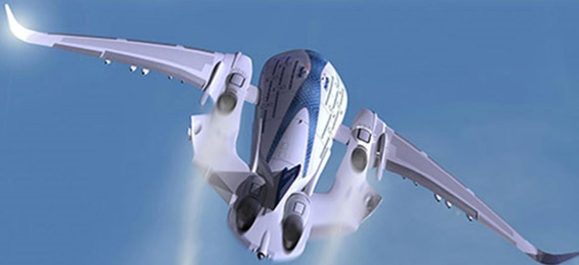
De plus, le Sky Whale innove aussi côté réservoirs. Dans les avions commerciaux actuels, le carburant est stocké dans les ailes de l'appareil. Le Sky Whale propose une astuce supplémentaire : un double fuselage qui permettrait d'emporter plus de carburant. Il pourrait donc parcourir de plus longues distances avant ravitaillement.
